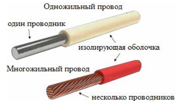
Рис. 15. Разновидности монтажных проводов
