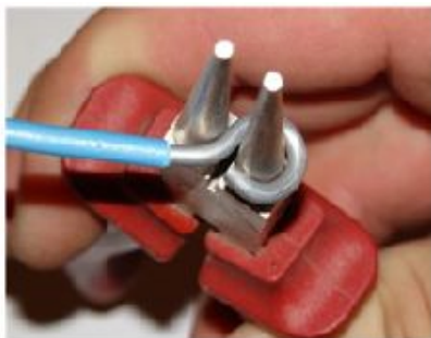
Рис. 2.2. Формовки колечка с применением круглогубцев
