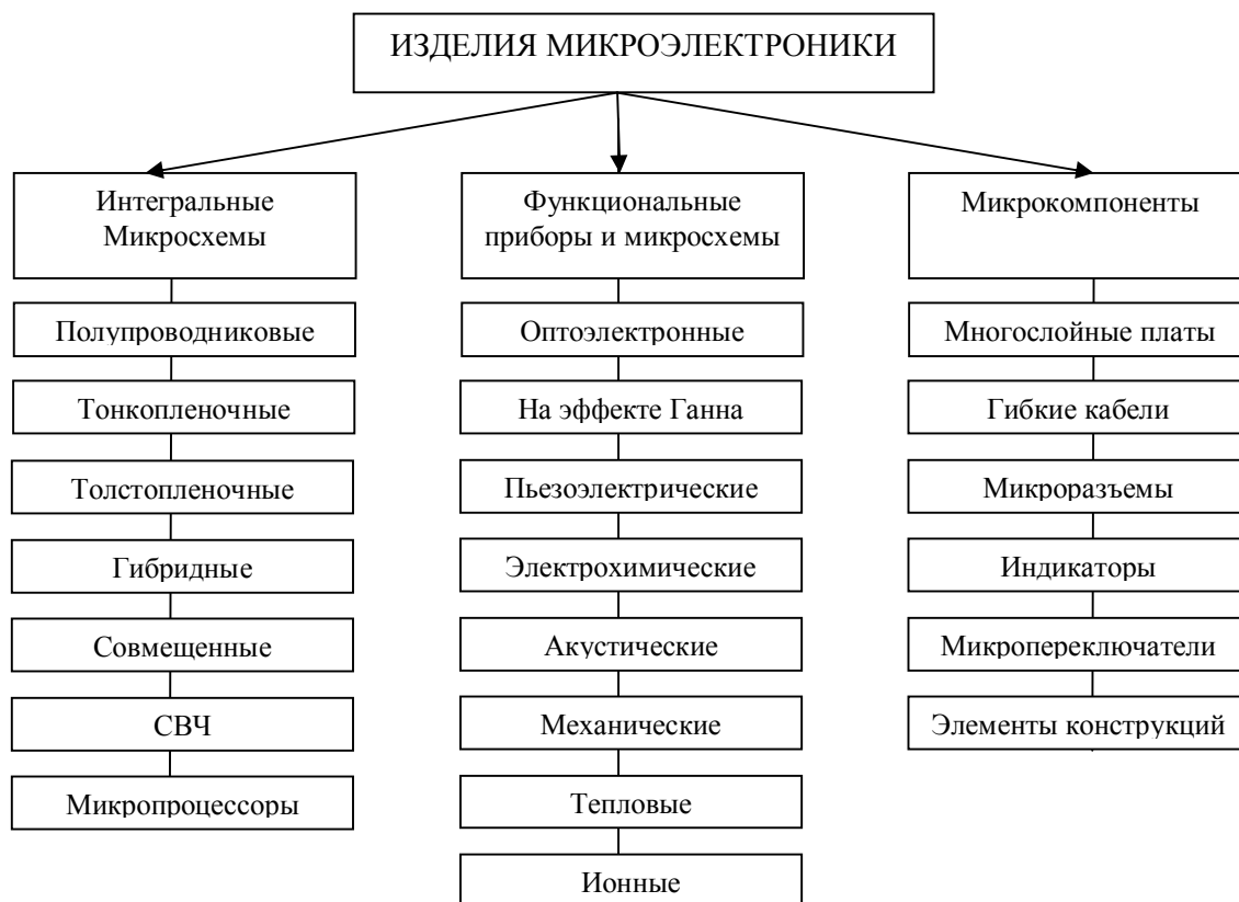
Рис. 1.1 Классификация микроэлектронных изделий
